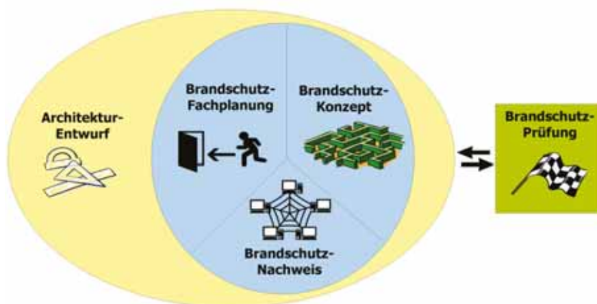
Abb. 6: Regelkreis des Brandschutzkonzeptes
