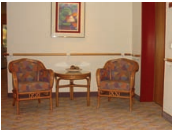
Bild 11: Sitzzecke engt den Rettungsweg eines Seniorenheims ein
