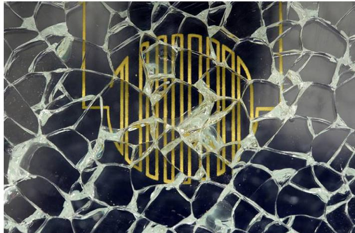
**Einscheibensicherheitsglas (ESG)** mit Alarmschleife besteht aus einer thermisch vorgespannten Glasscheibe die mit einer Leiterschleife (auch Alarmspinne genannt) versehen ist. Bei einem Angriff auf die Scheibe zerfällt diese in eine sehr große Zahl nicht scharfkantiger Bruchstücke. Dabei wird ebenfalls die Alarmschleife durchtrennt, und ein Alarm wird ausgelöst.
