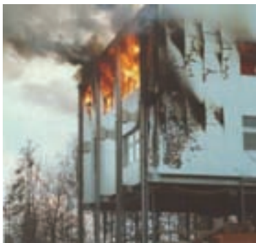
Bild 6.01: Ein Großbrandversuch mit Sandwichelementen als Außenbauteil
