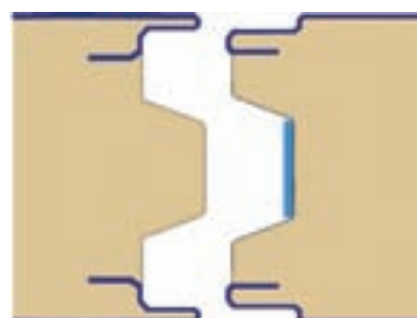
Bild 6.04: Überlappende Fuge mit einem Dichtungsband
